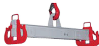
3 Je nach Situation Lasttraversen (Kranjoche) verwenden.
